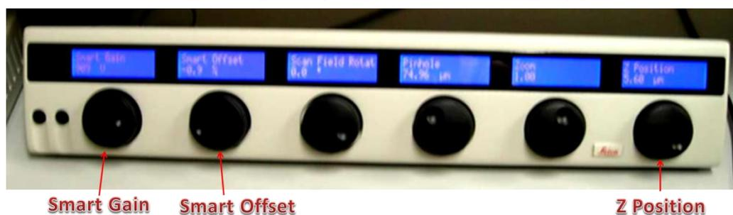
图像亮度动态范围可通过调节激光输出功率（见第 9 页图）、Smart Gain 和 Smart Offset（见上图）。
